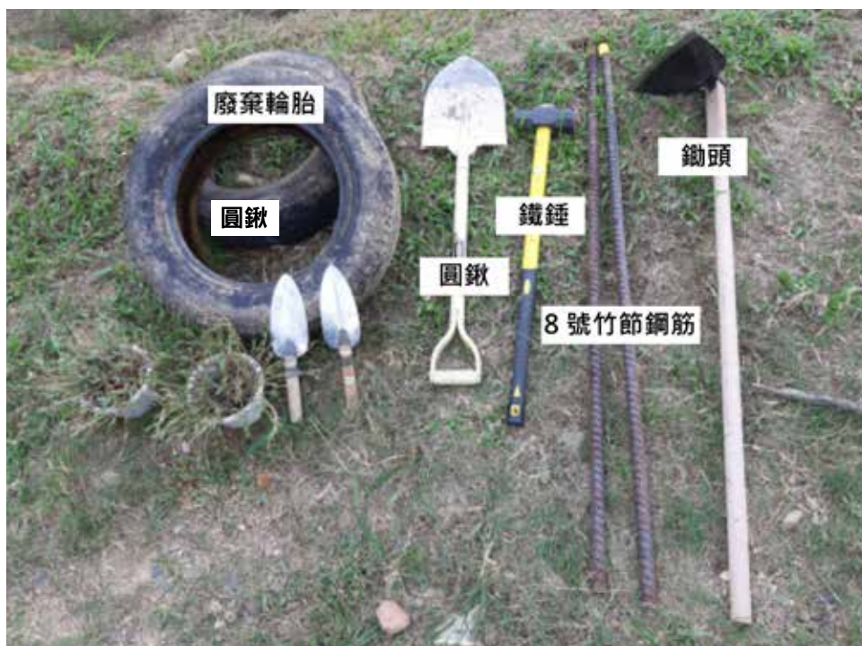
輪胎擋土牆材料工具（國際示範區，2018）
